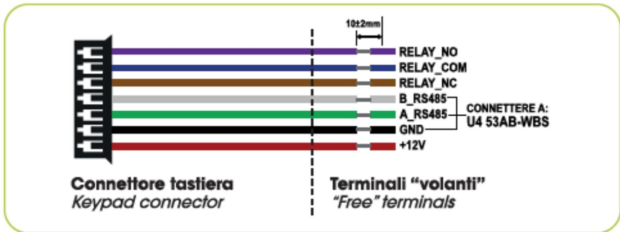
Nota: come si può notare dall'immagine sopra riportata, il negativo dell'alimentazione è in comune al GND del segnale RS485. È sufficiente collegare il morsetto negativo del 53AB-AUX al morsetto GND dell'ingresso U4 (53AB-WBS).
