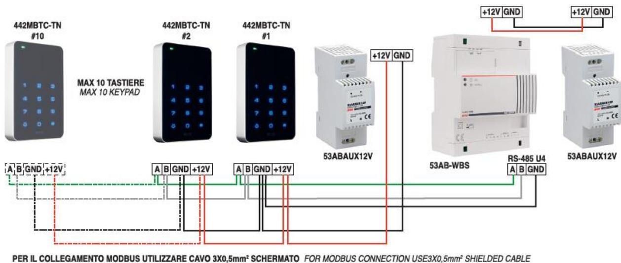
Nel dettaglio il collegamento di ogni tastiera sarà:
