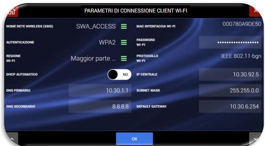
Esempio di configurazione Wi-Fi in modalità CLIENT .
