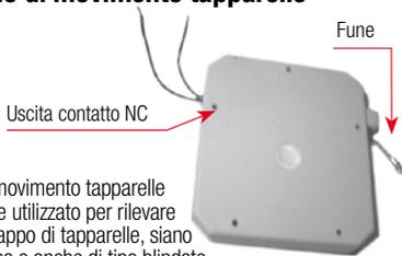
Il rivelatore a filo di movimento tapparelle AFRTP1 (fig. 1) viene utilizzato per rilevare il sollevamento e strappo di tapparelle, siano esse di legno, plastica o anche di tipo blindato. Lo stesso, partendo da una posizione iniziale, rileva il movimento di salita o di discesa della tapparella provocando l'apertura ciclica di un contatto di allarme NC.
