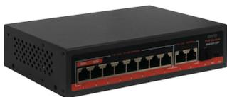
Switch PoE 8 porte 10/100/1000 Mbps per gamma IP V44 SMART. Può essere utilizzato per alimentare i supervisor domotici TS-SMART7xx e TS-SMART10xx e le postazioni esterne videocitofoniche IP. Il dispositivo è dotato di n.2 porte UP LINK e porta SFP. Dimensioni (LxHxP): 200x46x120 mm
